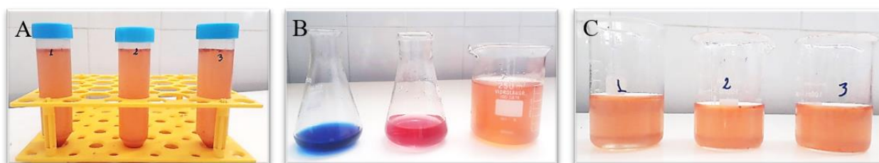
Figura 3.6 - Análise do teor de ácido ascórbico. (A) Amostras após a centrifugação; (B) Etapas da titulação – erlenmeyer com coloração azul: antes de iniciar a titulação, erlenmeyer com coloração rosa: durante a titulação; (C) Ponto final da titulação. Fonte: Arquivo pessoal.
