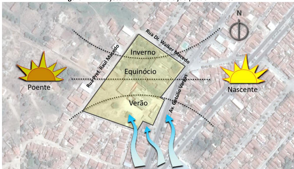
Figura 111: Trajetória solar e ventilação predominante.
