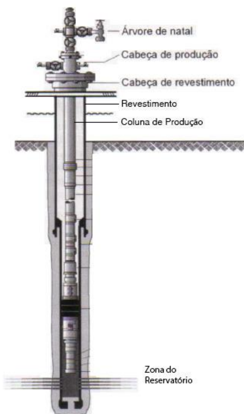
Figura 1.1 Representação simplificada de um poço de petróleo (Adaptado da Figura 6.13 de Thomas (2004).)
