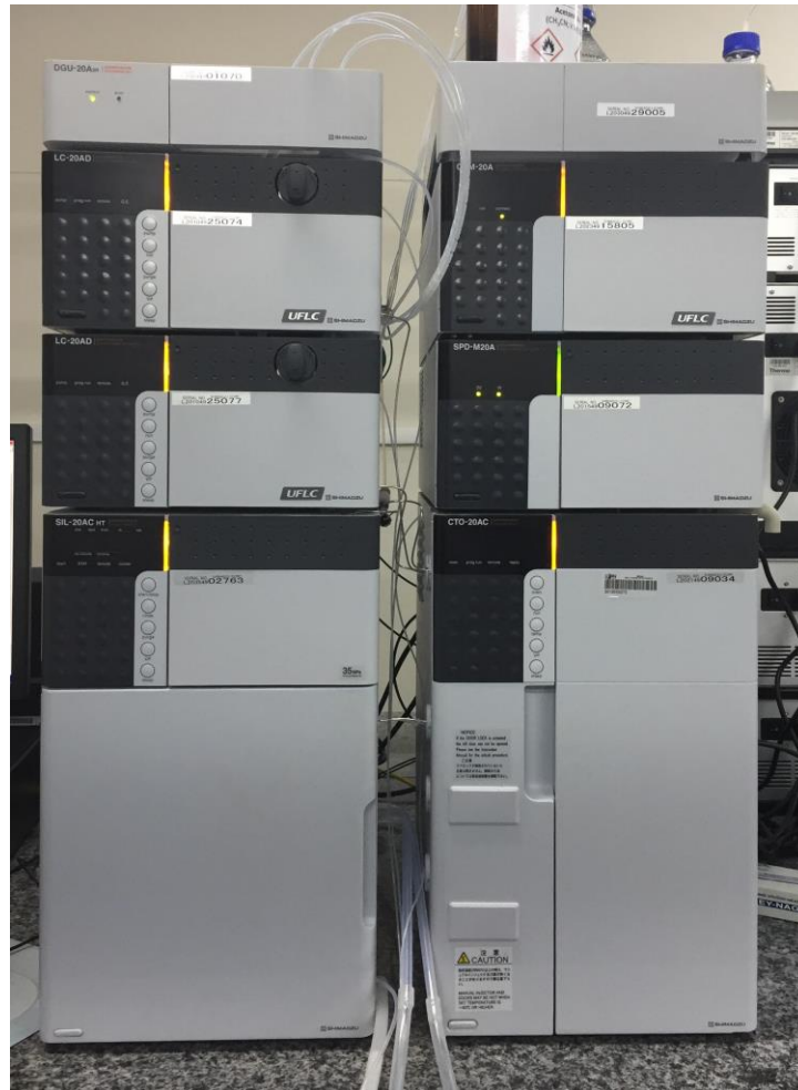
Figura 13. Cromatógrafo líquido da marca Shimadzu utilizado para análise das amostras.
