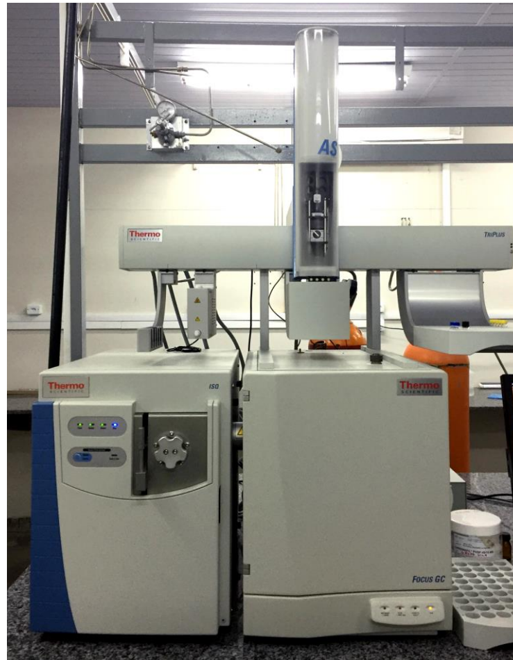
Figura 12. Cromatógrafo a gás FOCUS GC utilizado para análise das amostras.
