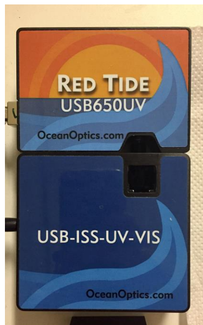
Figura 11. Espectrômetro UV-Vis utilizado para análise das amostras
