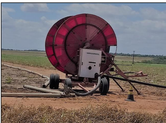
Figura 14. Arês/RN: Carretel empregado para irrigação da cana-de-açúcar (2018).
