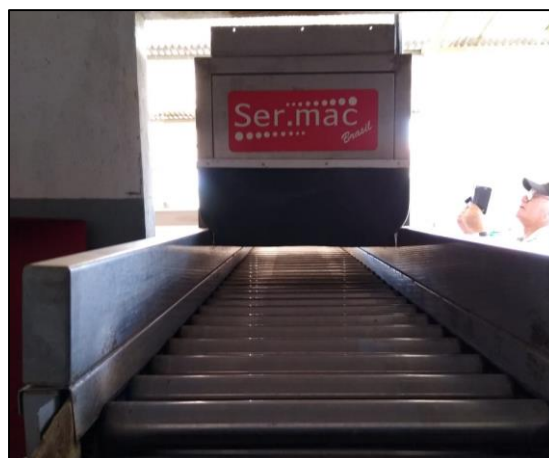
Figura 50. Assú/RN: esteira de seleção e classificação das melancias na packing house (2019).
