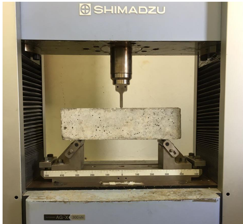
Figura 17 – Ensaio de tração na flexão com carregamento no ponto central
