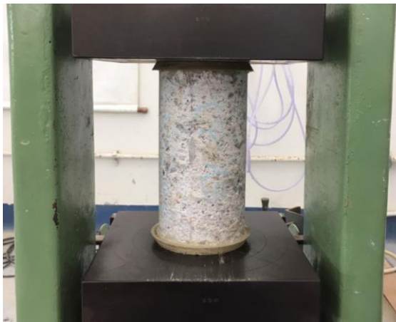
Figura 16 - Ensaio de compressão axial
