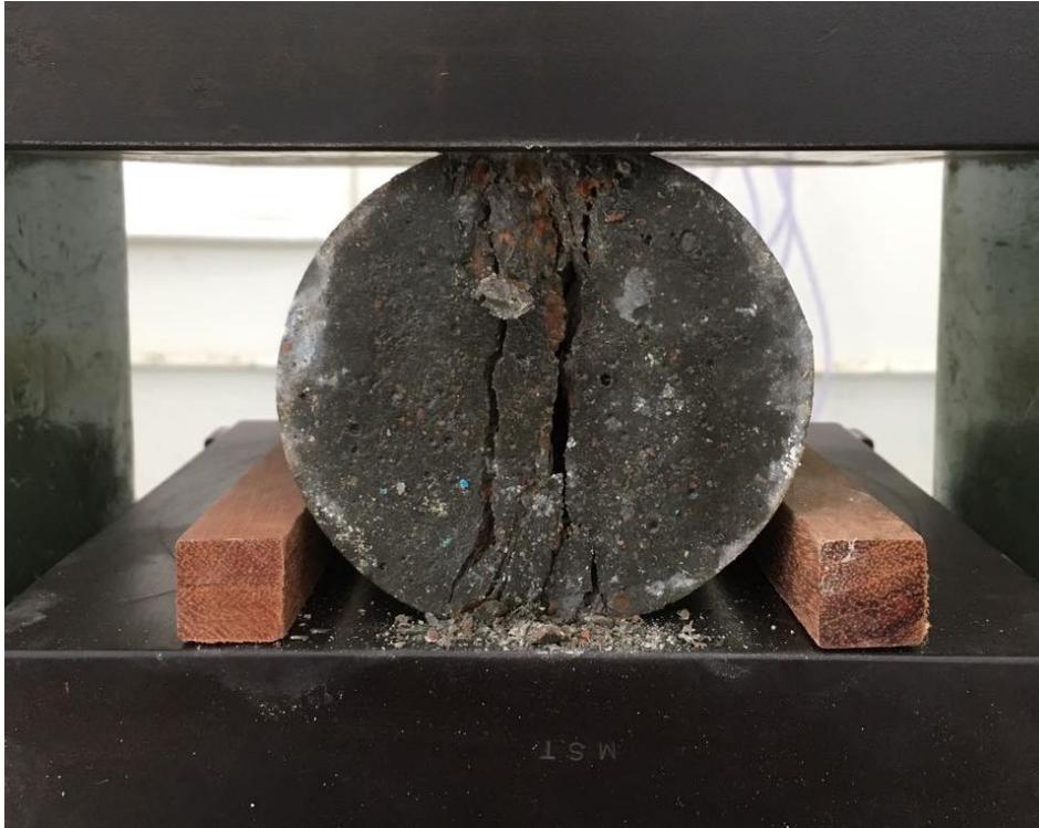
Figura 20 – Ensaio de compressão diametral
