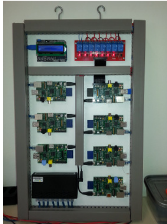
Figura 5.1: NPi-Cluster montado com 7 nós (Alves Filho et al. 2017).
