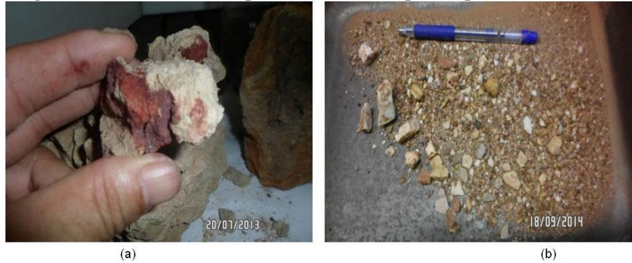
Figura 31- (a) solo do Brasil (plintita) e (b) área e pseudo partículas de “areia”
