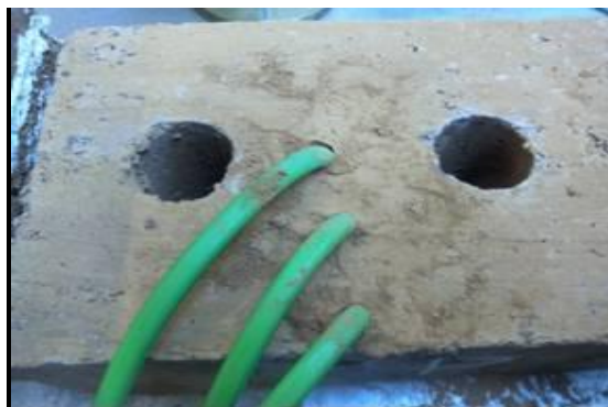
Figura 22–detalhes de ligação das sondas nos orifício dos blocos de solos–cimento
