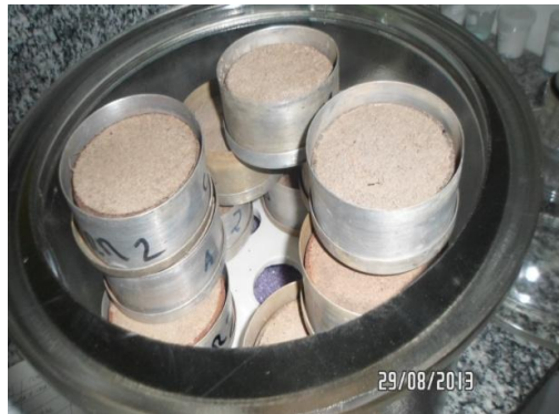
Figura 12–Amostra do solo preparada para determinação da densidade e teor de água
