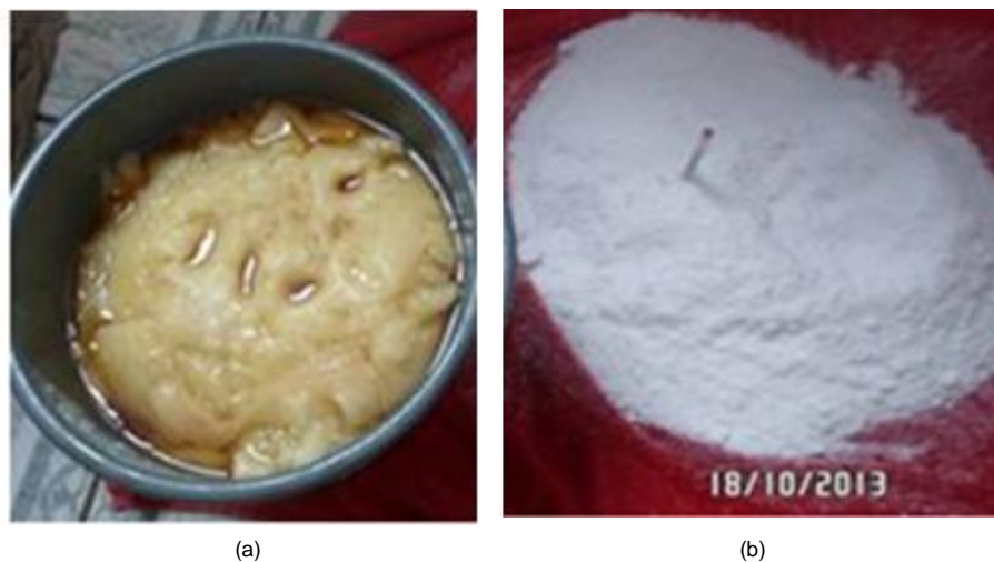
Figura 10–Tipo de parafinas adicionada a argamassa para a fabricação do bloco
