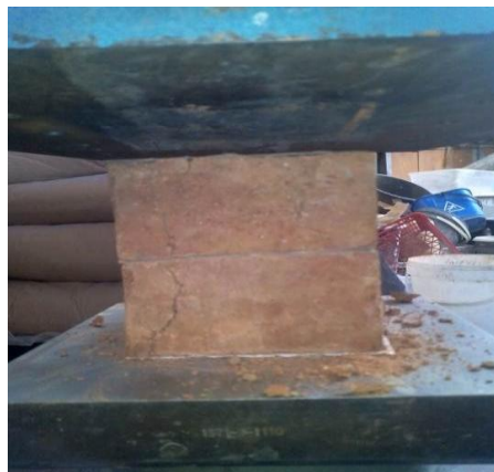
Figura 15–Bloco de solo - cimento sendo ensaiado
