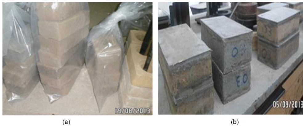
Figura 14–Blocos de solo–cimento para ensaios de resistências a compressão simples
