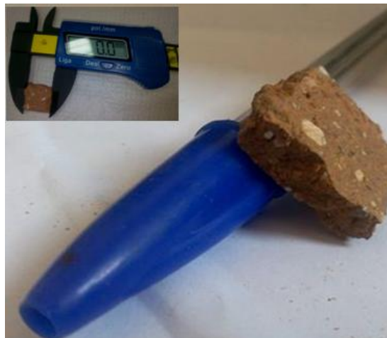
Figura 17 - bloco de solo–cimento para microanálise
