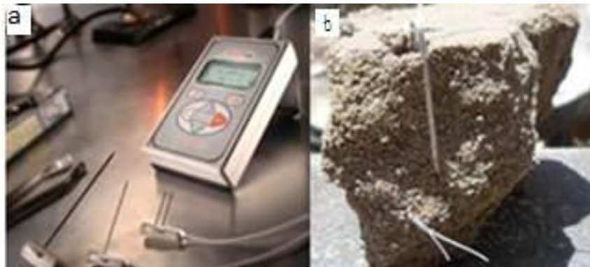
Figura 18–Equipamento KD2 Pro e gabarito figura.
