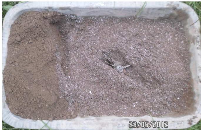
Figura 34–Aspecto geral do solo cimento pronto para prensagem com MMFs
