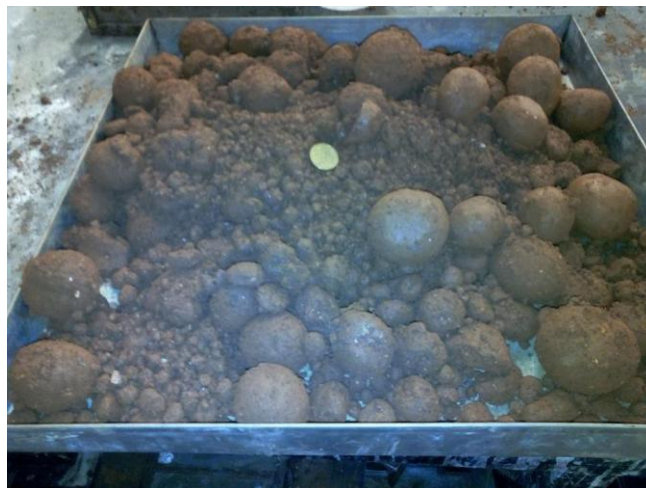
Figura 33–Solo–cimento com base no teor de águas obtido por Procter
