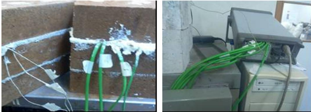
Figura 23–Blocos de solo–cimento câmara quente sondas e data logger
