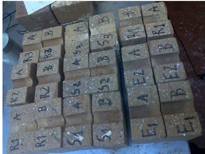
Figura 16–Blocos de solo–cimento para ensaios mecânico e microanálise
