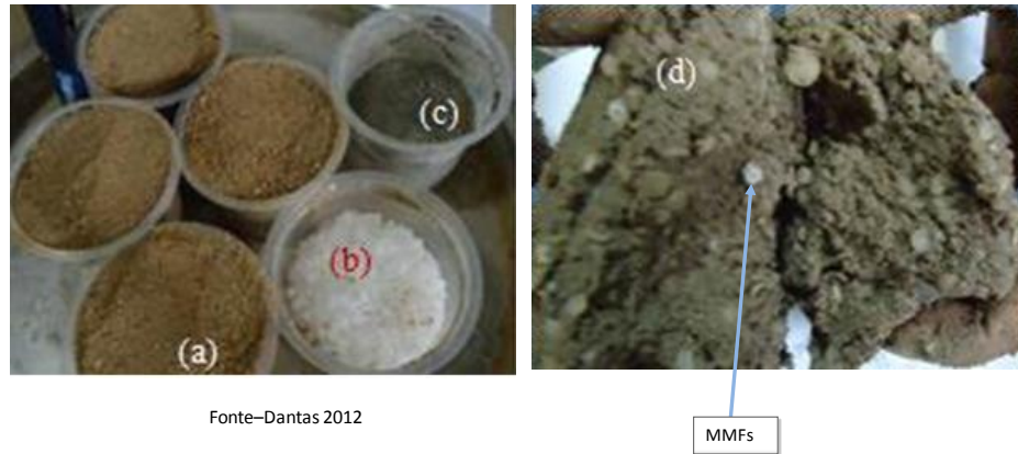
Figura 8–Detalhes das quantidades e as características da argamassa
