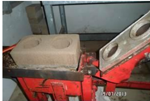
Figura 13–Prensa manual para blocos de solo–cimento do Brasil
