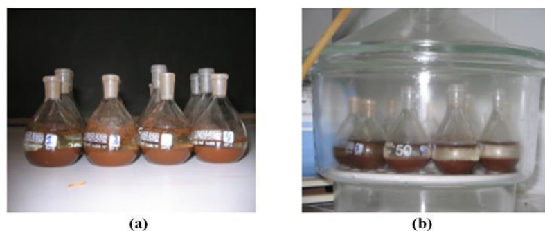
Figura 7–Densidade real (pp) pelo método de picnometria com álcool.
