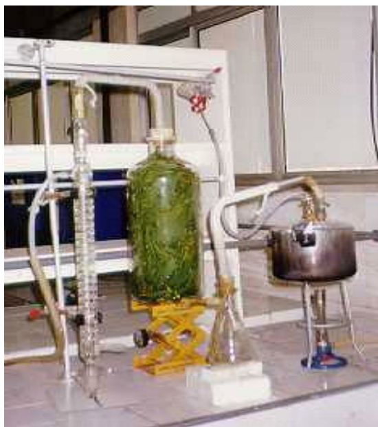
Figura 9. Dispositivo para extração de óleos essenciais por arraste a vapor
