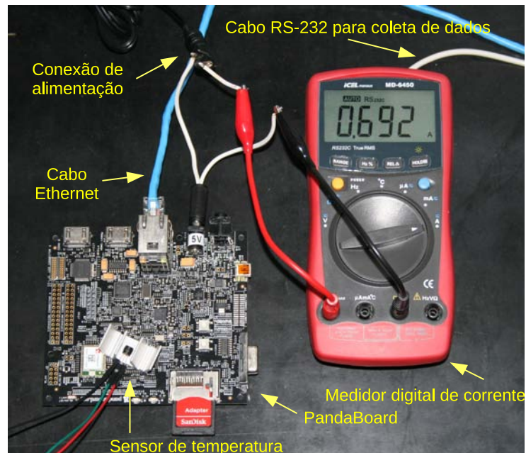
Figura 5.11: Foto com o ambiente de teste de performance dos processadores ARM.
