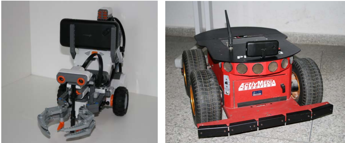
Figura 5.3: Dois robôs comerciais controlados pelo Anwide: um Lego Mindstorms e um Pioneer P3AT. Note o telefone fixado na parte superior dos dois robôs.
