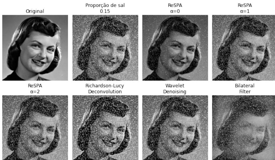
Figura 37 – Processamento da imagem Img4 com proporção de 0.15 de sal.
