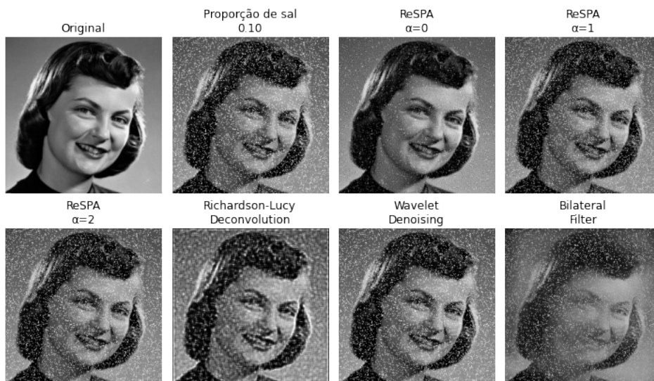
Figura 31 – Processamento da imagem Img4 com proporção de 0.10 de sal.
