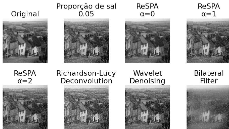
Figura 27 – Processamento da imagem Img6 com proporção de 0.05 de sal.
