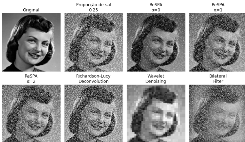
Figura 49 – Processamento da imagem Img4 com proporção de 0.25 de sal.
