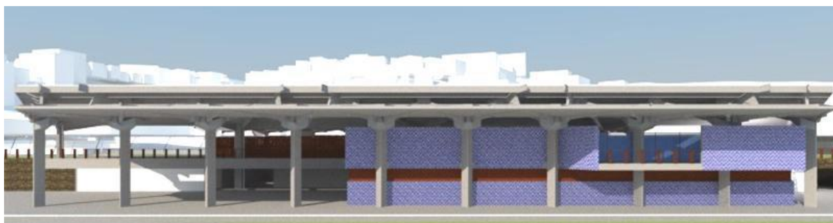
Figura 28 - Estrutura em aço corten projetada e destaque ao painel de azulejos existente.
