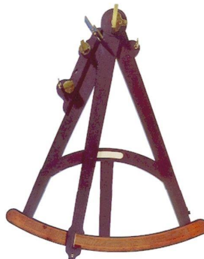
Figura 3: O instrumento Octante Reflexivo
