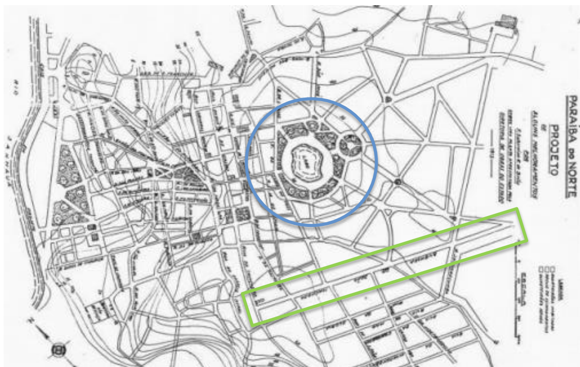
Figura 20 – Projeto de alguns melhoramentos e de expansão da cidade da Parayba do Norte, elaborado por Saturnino de Brito em 1913. Em azul, a Lagoa dos Irerês; em verde, Avenida João Machado. Fonte: VIDAL, 2004.
