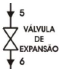
Figura 12 – Volume de controle da válvula de expansão do refrigerante. Fonte: (Santos, 2005)
