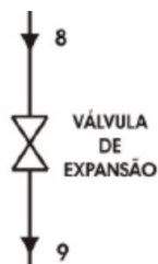
Figura 12 – Volume de controle da válvula de expansão do refrigerante. Fonte: (Santos, 2005)
