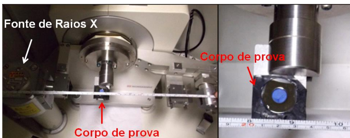
Figura 29- Adaptação do porta amostra para a análise de DRX.
