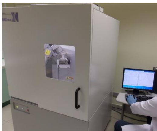
Figura 34 – Difratômetro de raios X equipado com o módulo “stress”
