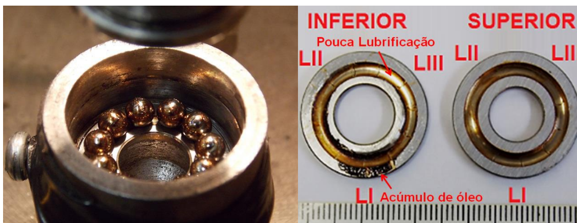
Figura 63 – Registro fotográfico após o ensaio lubrificado (SAE 40)
