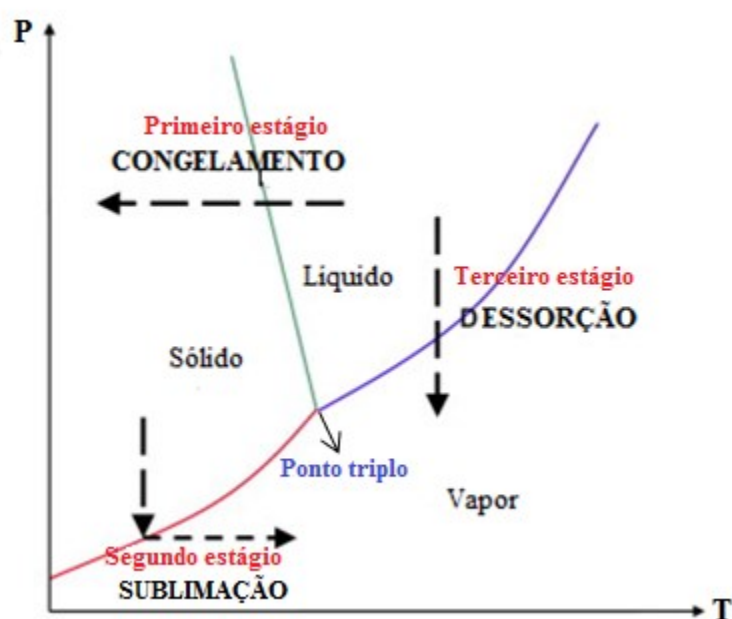
Figura 2.8: Etapas da liofilização representadas pelo diagrama de fases. Primeiro estágio: A amostra é resfriada até a formação dos cristais de gelos. Segundo estágio: consiste no aquecimento da amostra sob condições de pressão abaixo do ponto triplo. Terceiro estágio: consiste na retirada da água ainda ligada a estrutura porosa da amostra. Adaptado de Lopez-Quiroga et al. (2012).
