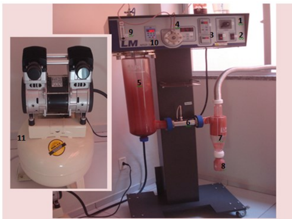
Figura 2.11: Secador do tipo spray dryer modelo MSD 1.0 com identificação dos principais sistemas: 1- Chave geral, 2- Controle do aquecimento, 3- Indicador de temperatura, 4- Controle de bombeamento de líquido, 5- Câmara de secagem, 6- Conector inox, 7- Separador de produto seco (ciclone), 8- Frasco coletor de produto seco, 9- Rotâmetro, 10- Controlador da vazão do soprador, 11- Compressor de ar. Fonte: Arquivo pessoal (2012).
