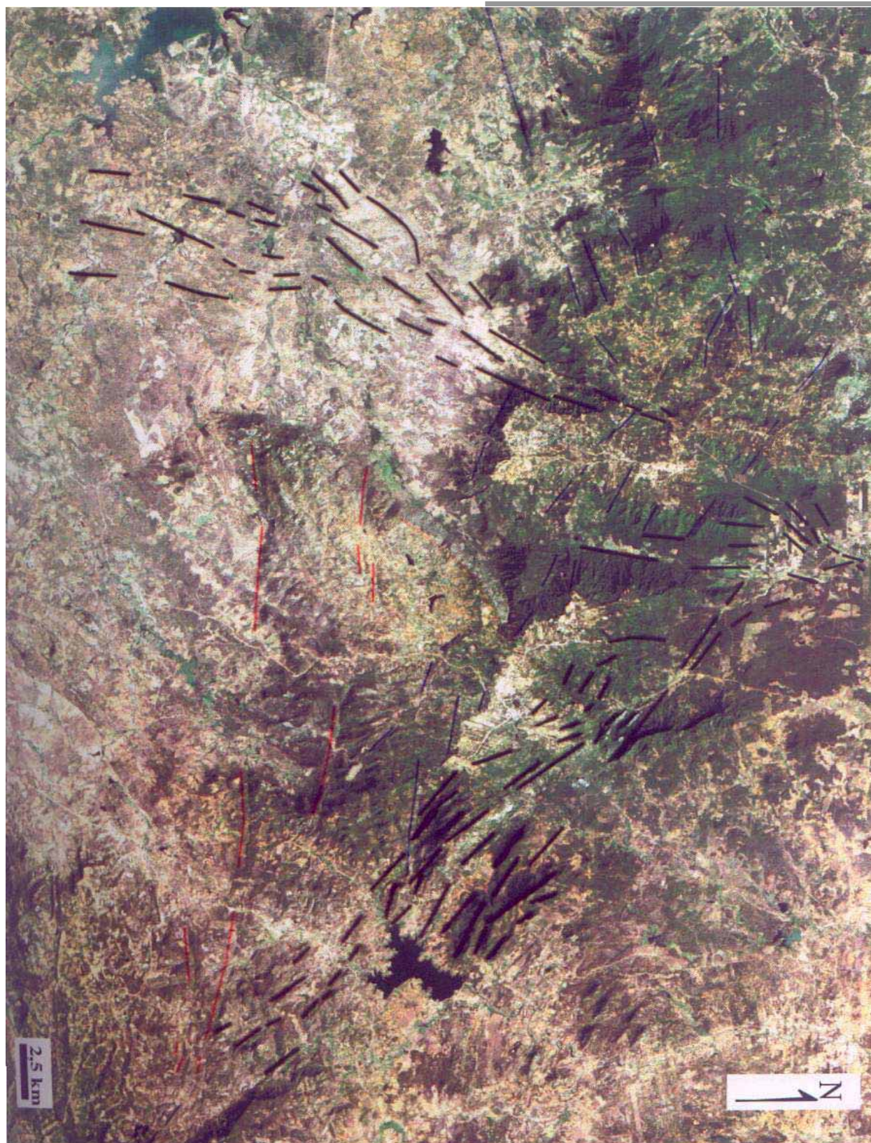
Figura 6.2 - Imagem digital LANDSAT TM 5 dos platôs de Portalegre e Martins, tratada em composição RGB (espectro do red, green, blue), com os principais lineamentos fotointerpretados na transparência.
