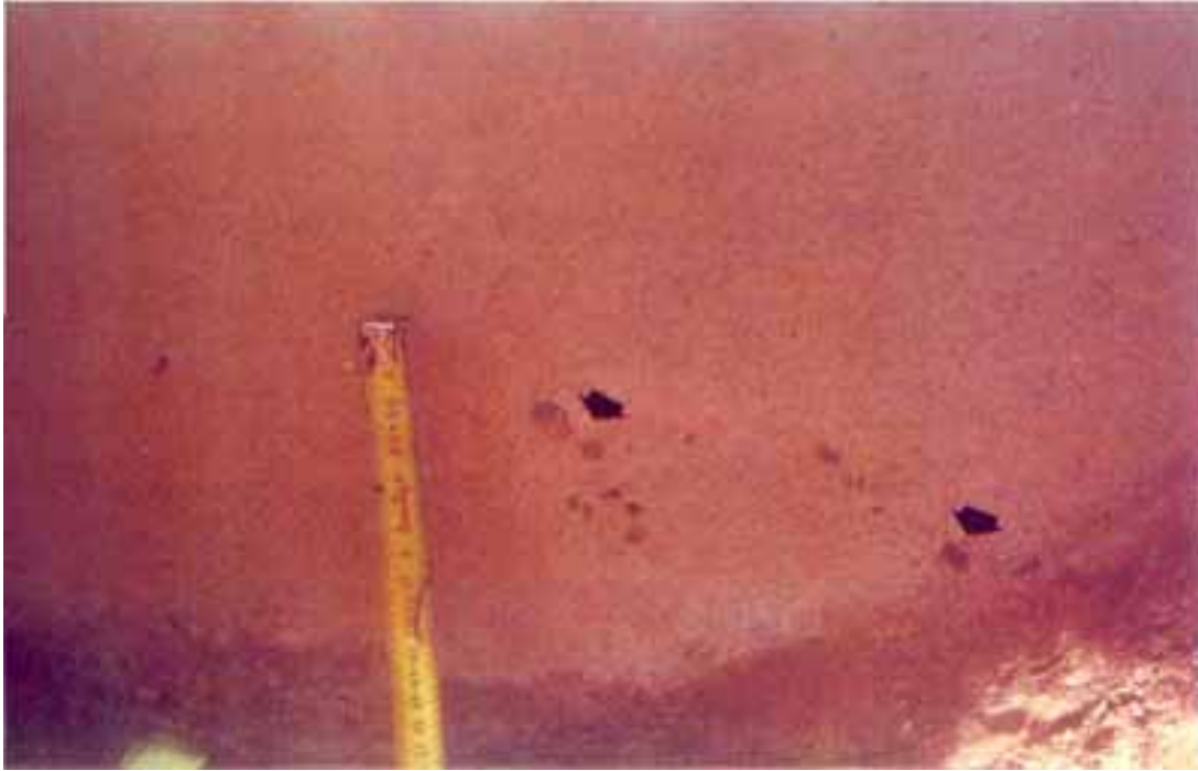
Foto 4.1 – Arenito fino, maciço, da Fácies Arn fmg, com seixos flutuantes de quartzo em meio à granulometria predominantemente fina da rocha.
