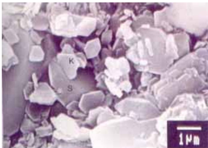
Foto 5.13 – Plaquetas de caulinita (K) parcialmente envolvidas por cristais prismáticos de sílica (S), denunciando a precipitação precoce de caulinita em relação à sílica. Microscópio eletrônico de varredura.
