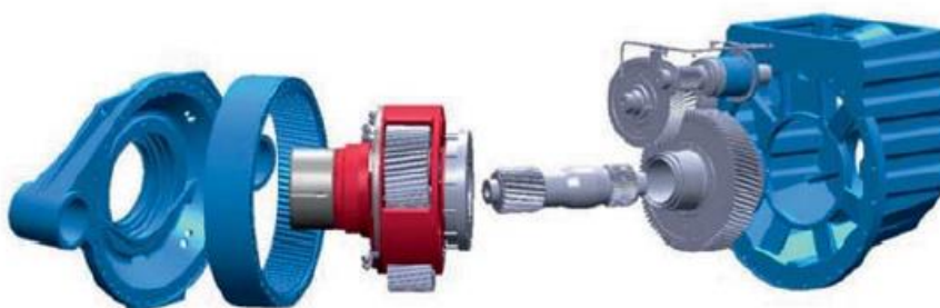
Figura 4.11 - Caixa multiplicadora de um aerogerador Fonte: US Department of Energy, U.S. Government (2014)
