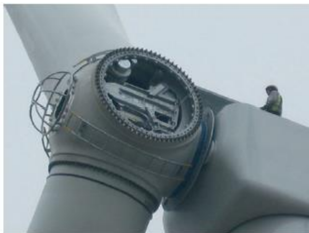
Figura 4.6 - Cubo de um aerogerador Fonte: Foto de Paul Anderson em Karimirad (2014)
