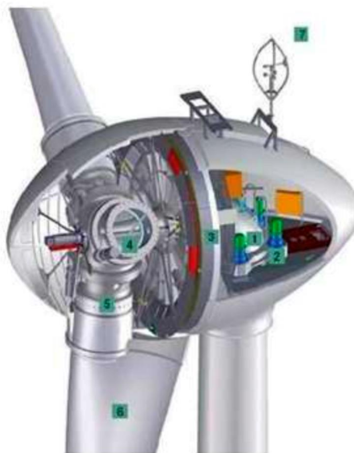
Figura 4.9 - Vista do interior de nacela de um aerogerador sem caixa multiplicadora, com gerador multipolos.
