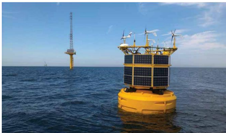
Figura 4.14 - LIDAR operando sobre boia em ambiente marítimo Fonte: Axys Technologies (2015)
