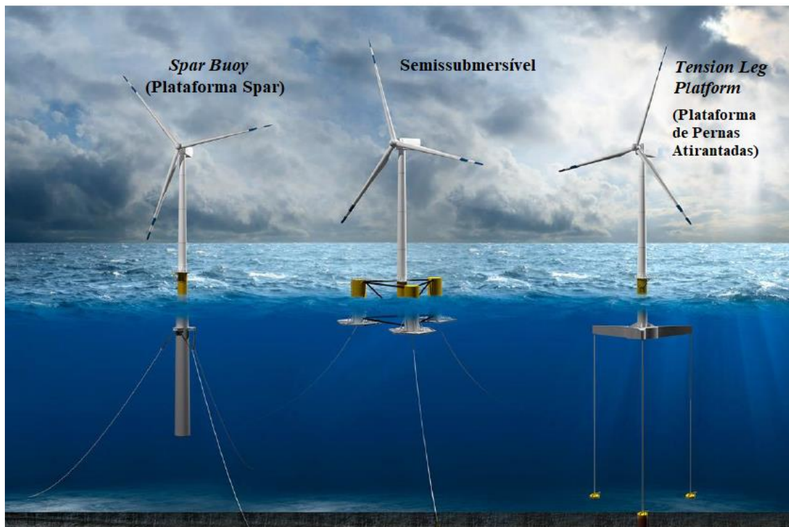
Figura 4.3 - Principais tipos de fundações flutuantes Fonte: Adaptado de Joshua Bauer, NREL, US Department of Energy (2016)
