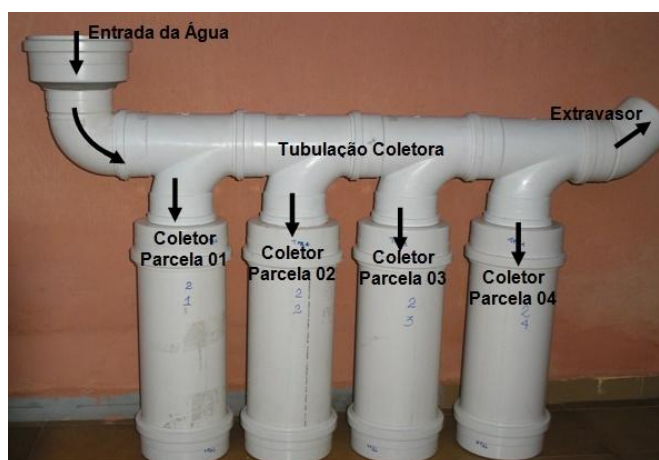
Figura 4.10 Amostrador composto e esquema de funcionamento
