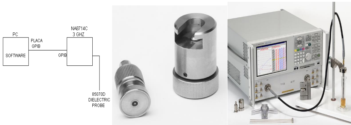
Figura 8.13 – Configuração do conjunto do sistema Set Up , imagem da Probe , do calibrador, do Network Analyzer e dos cabos coaxiais para a medição de K.
