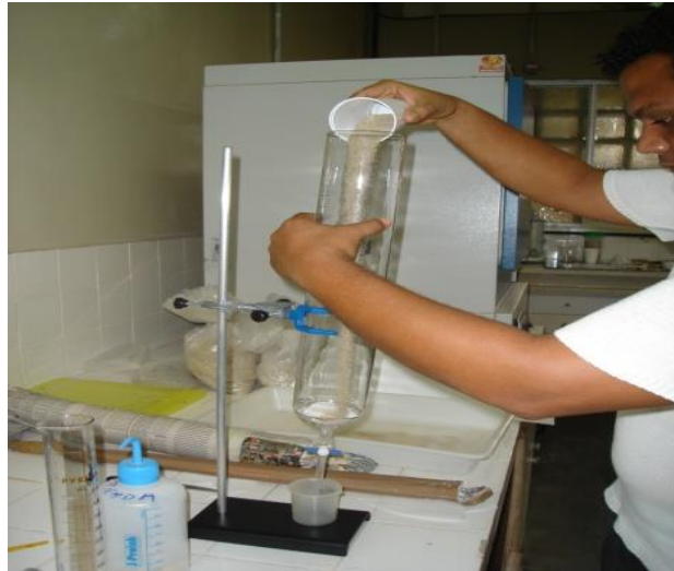
Figura 8.12 – Amostra de areia inserida na bureta para posterior saturação com água destilada.
