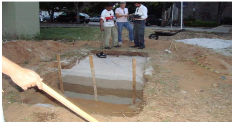
Figura 8.4 – Fotografia do segundo experimento onde podem ser visualizadas as camadas de brita, areia grossa e areia fina, obtida durante a aquisição GPR, no sentido diagonal.
