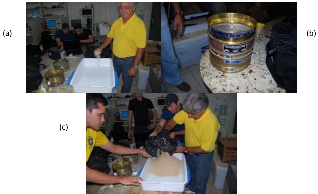
Figura 8.8 – Separação granulométrica das areias de duna para o experimento. Bandeja plástica onde foram colocadas as amostras (a); conjunto de peneiras utilizadas para separação das amostras de areia (b). Colocação da fração areia com diâmetro médio de 0,250mm (c) na bandeja plástica utilizada.
