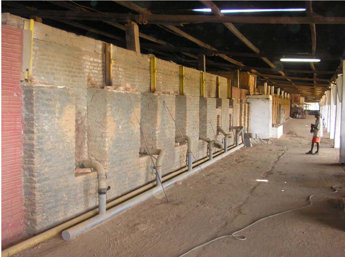
Figura 4.1 - Vista parcial do forno túnel convertido (de forma artesanal) para gás natural.
