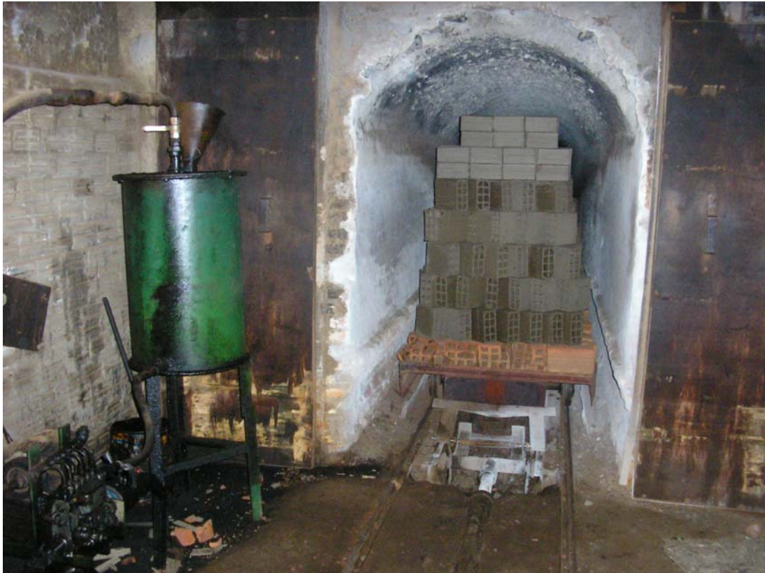
Figura 2.5 – Detalhe do mecanismo hidráulico que move as vagonetas.
