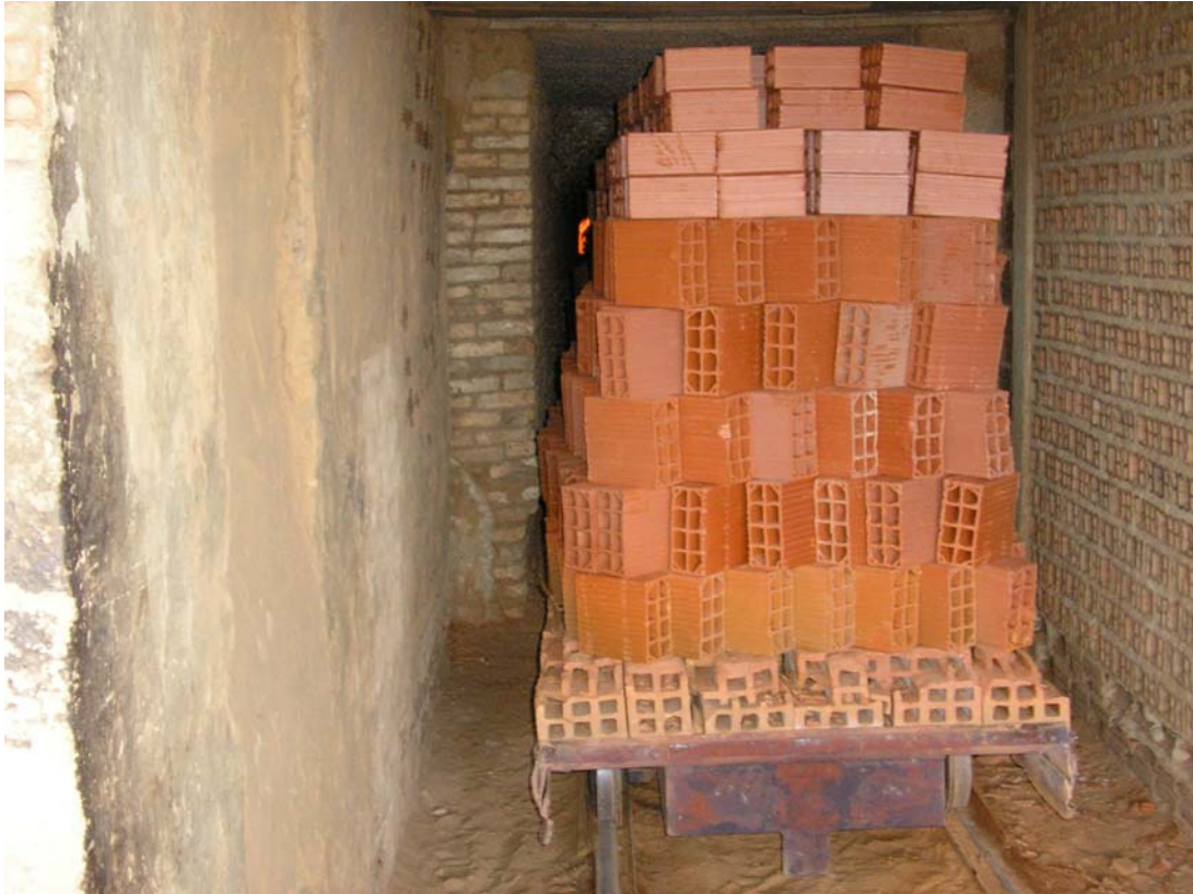
Figura 2.8 – Vagoneta com tijolos (19 cm x 19 cm x 9 cm) na saída do forno túnel.
