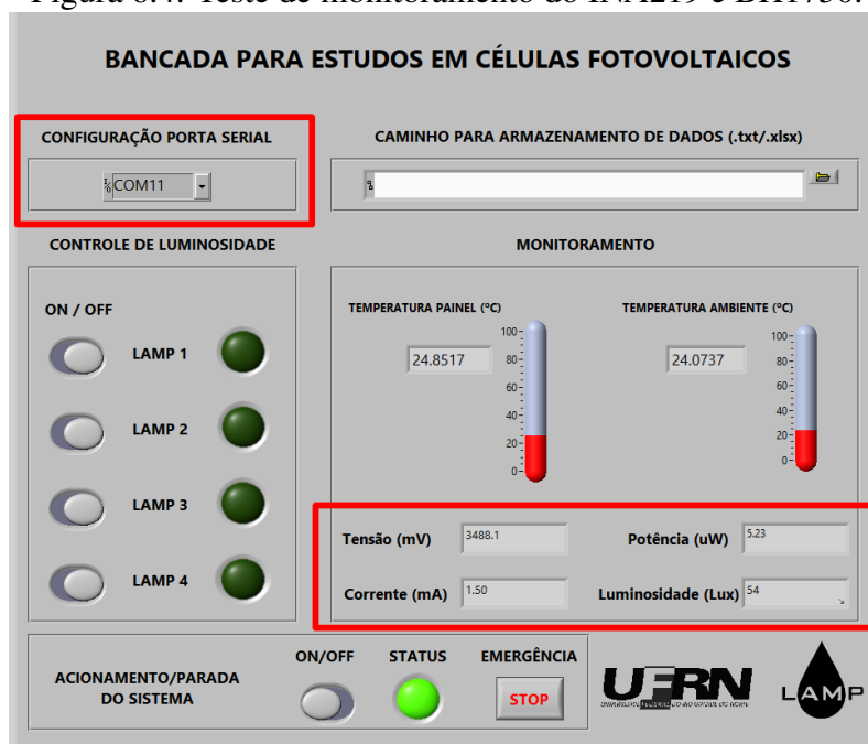
Figura 6.4: Teste de monitoramento do INA219 e BH1750.
