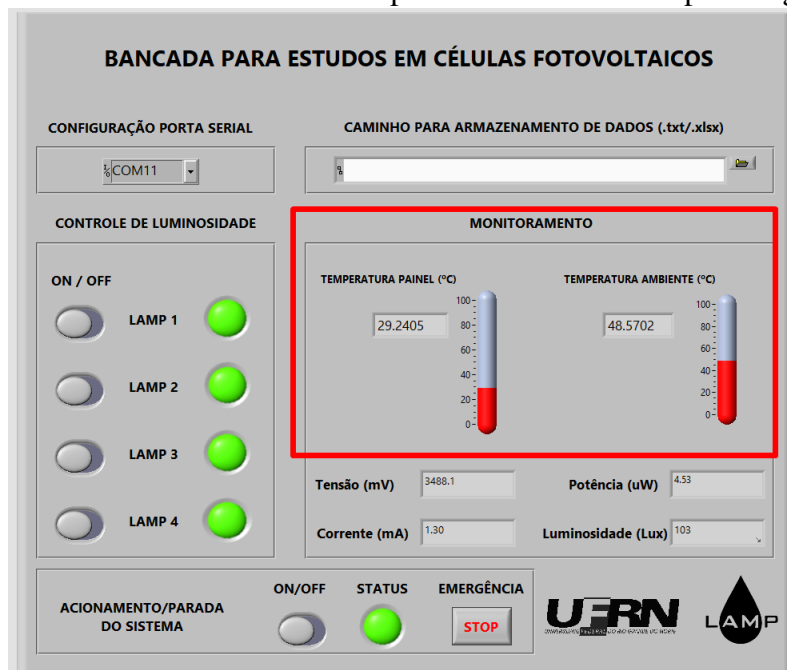
Figura 6.5: Monitoramento de temperaturas com as 4 lâmpadas ligadas.
