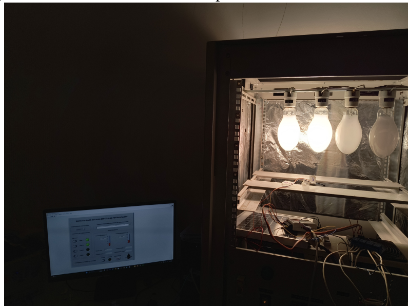
Figura 6.1: Sistema acionado com apenas 50% de luminosidade total.
