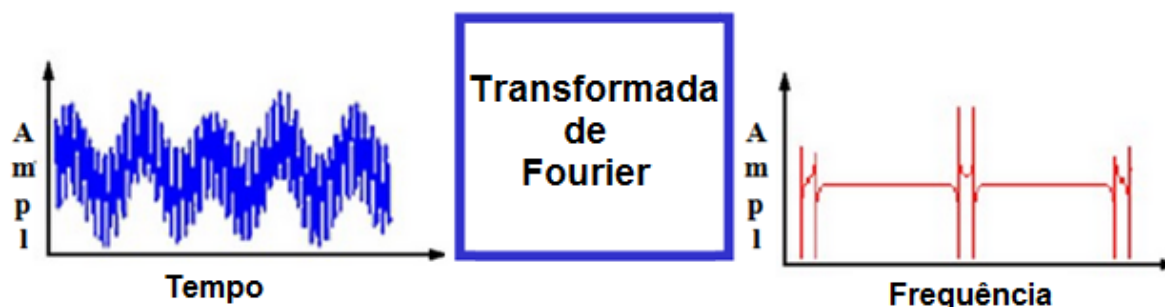
Figura 16 - Representação da Transformada de Fourier.
