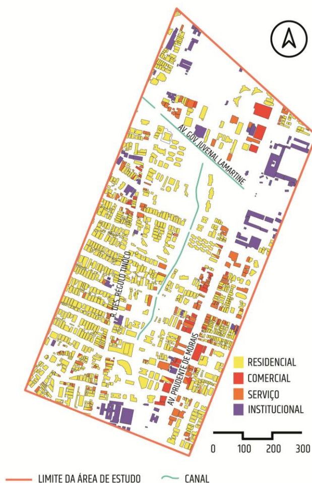
Figura 8 – Predominância do uso residencial e eixo comercial na Avenida Prudente de Moraes
