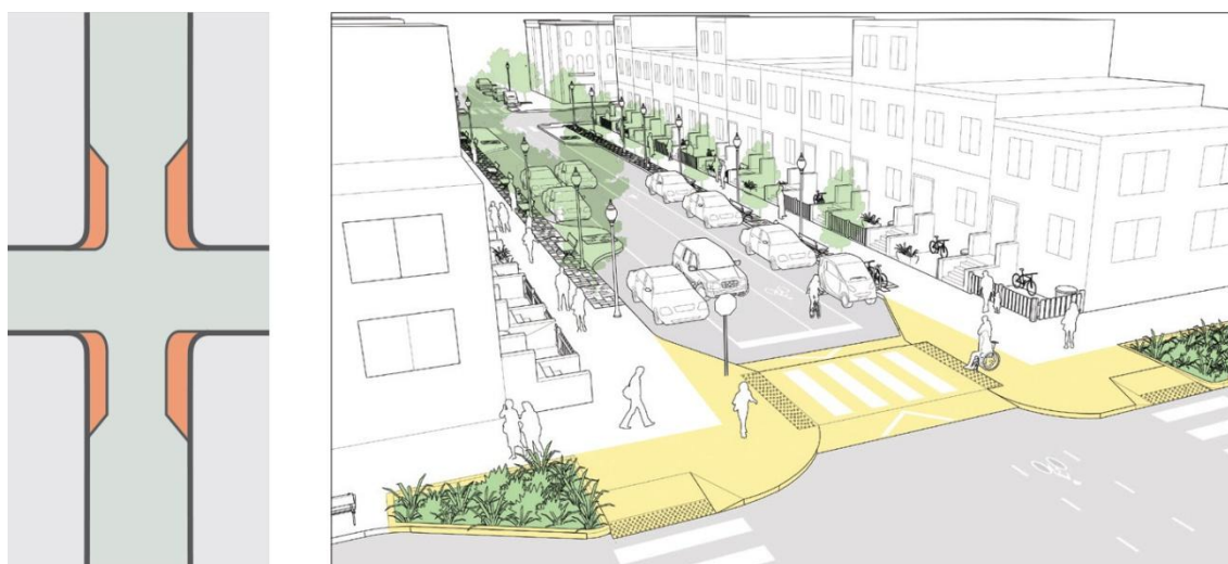
Figura 56 – Espaço do automóvel reduzido seguido de elevação, forçando a redução da velocidade antes da travessia
