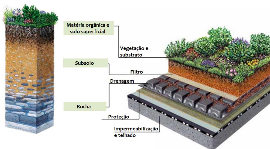
Figura 26 - Estrutura de um telhado verde
