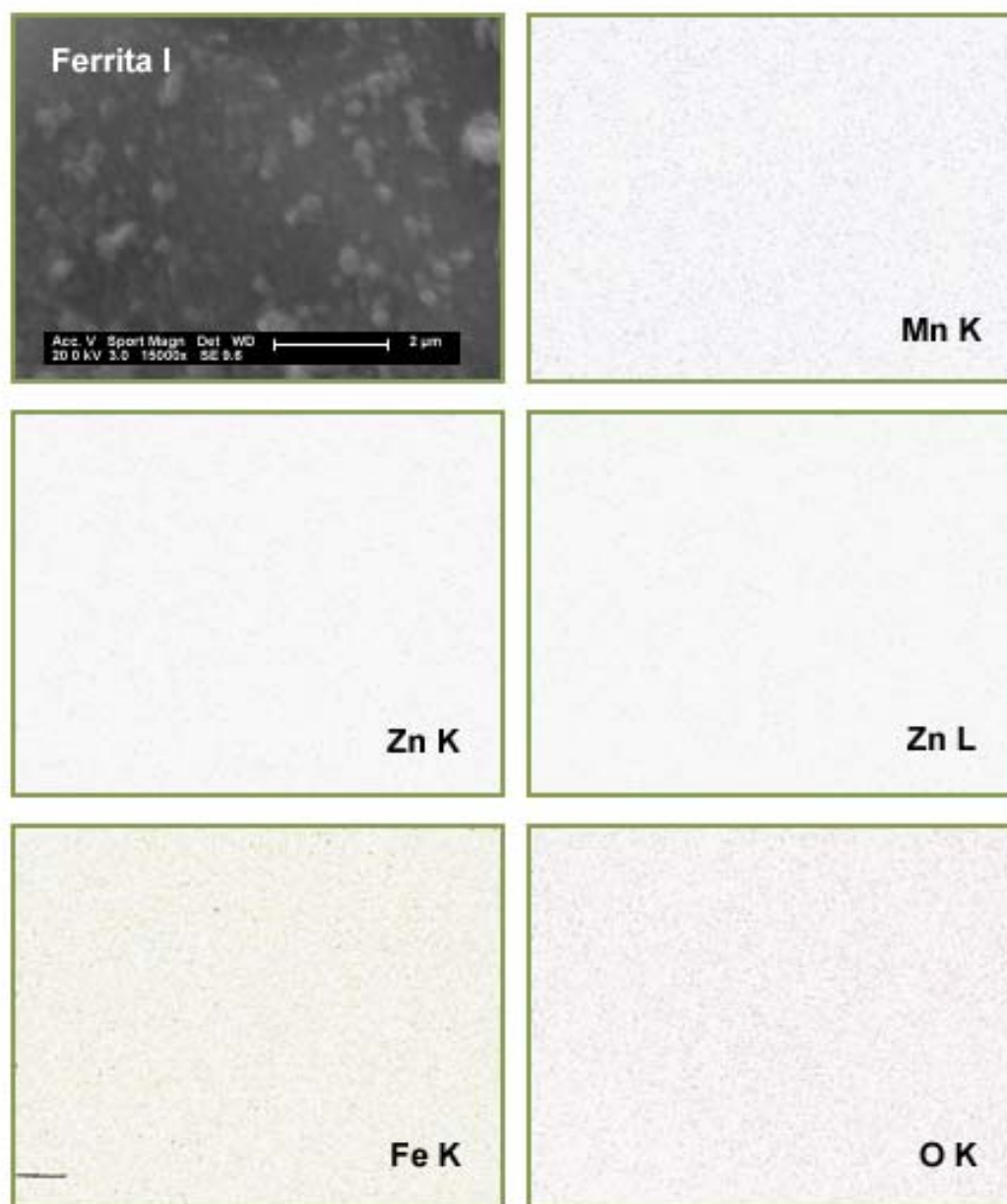
Figura 27 – Mapeamento das linhas K\alpha dos elementos Mn, Zn, Fe e O por EDS da amostra F-I calcinada a 350°C/3,5h sem controle da atmosfera.
