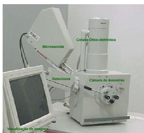
Figura 13 – Microscópio Eletrônico de Varredura – Modelo XL 30 da Phillips.
