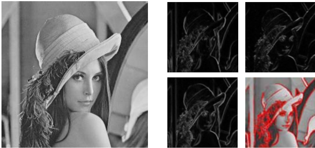
Figura 4.1: Imagem original (esquerda). Imagens obtidas a partir da extração das bordas verticais e horizontais da imagem original (superiores à direita). Combinação das bordas verticais e horizontais e superposição de bordas na imagem original (inferiores à direita).
