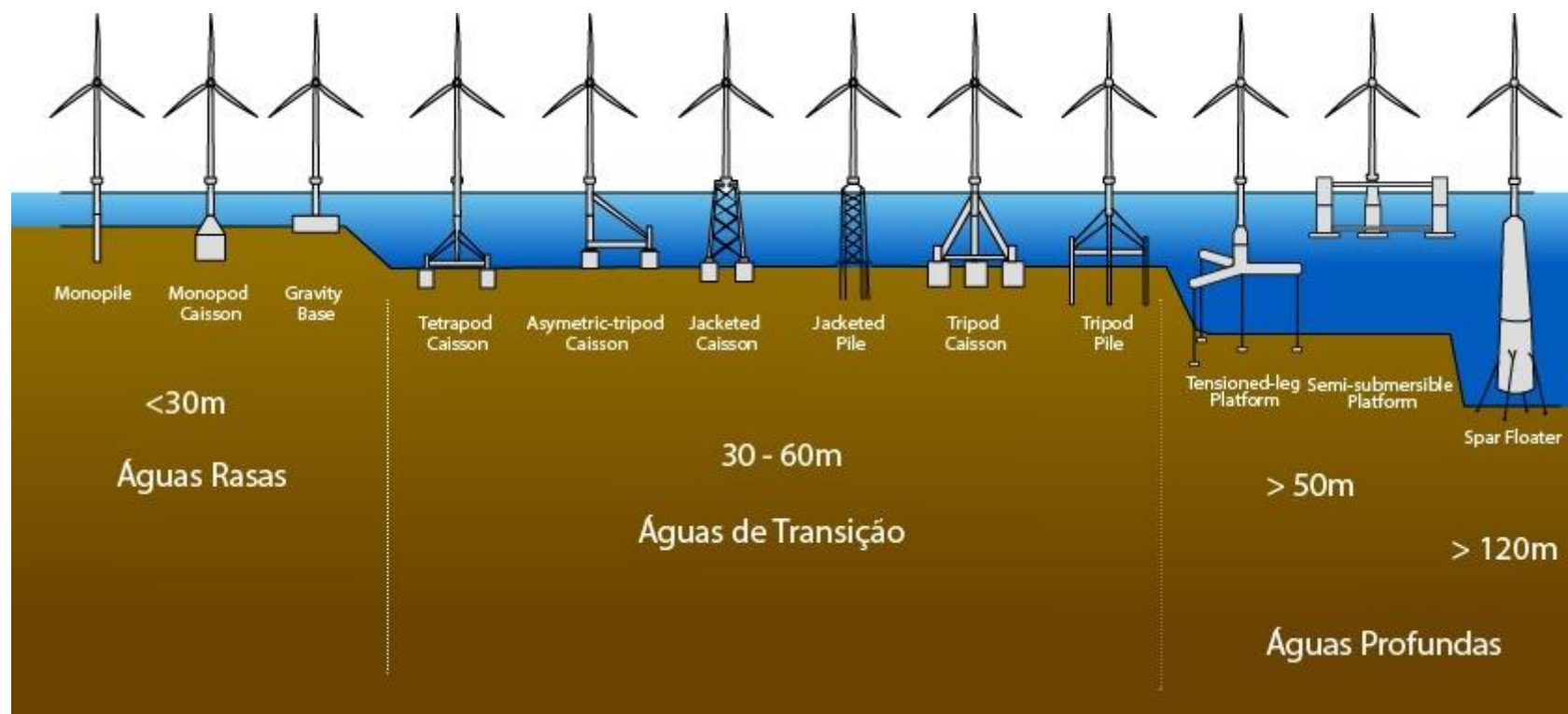
Figura 5.6 - Tipos de fundação e sua profundidade adequada.
