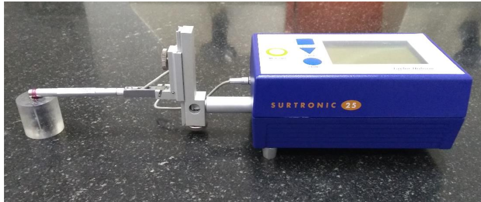
Figura 24 – Medição da rugosidade em uma amostra do aço AISI D6.
