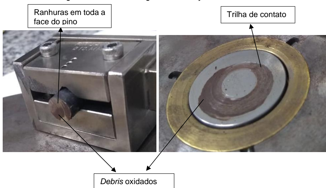
Figura 40 – Par tribológico da condição T&P-2.
