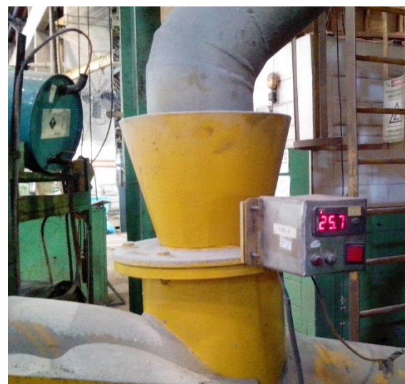
b) Verificação da temperatura da areia
