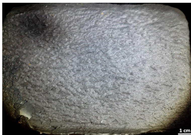
Figura 80: Amostra dos experimentos que mais evidenciou o defeito de acabamento superficial
