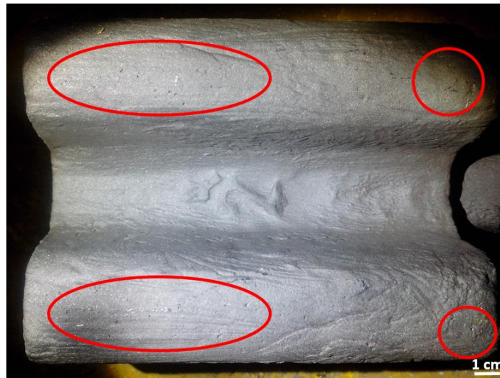
Figura 76: Amostra dos experimentos que mais evidenciou o defeito de porosidade
