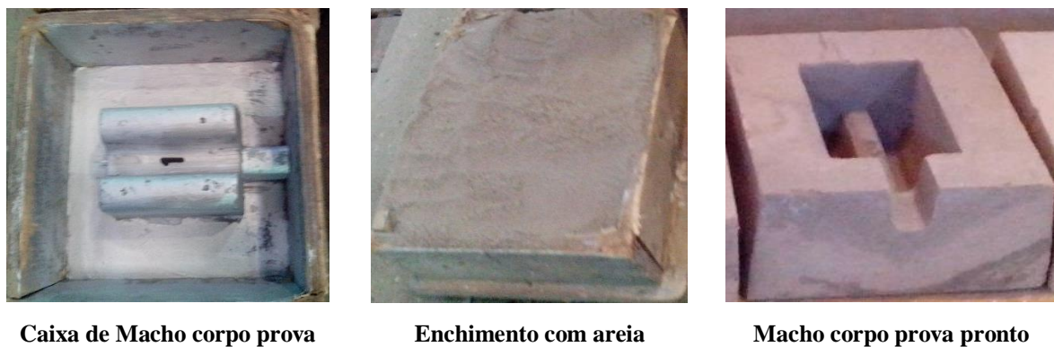
Figura 31: Sequência da fabricação das caixas de machos
