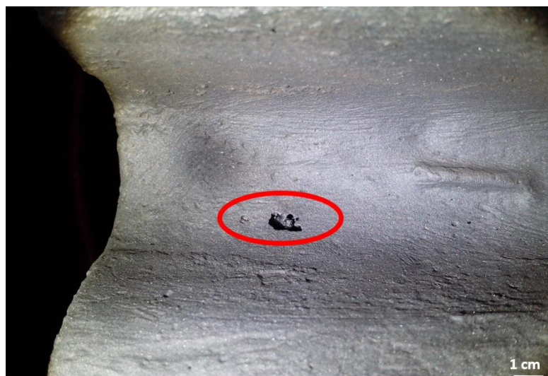
Figura 68: Amostra dos experimentos que mais evidenciou o defeito de inclusão de areia
