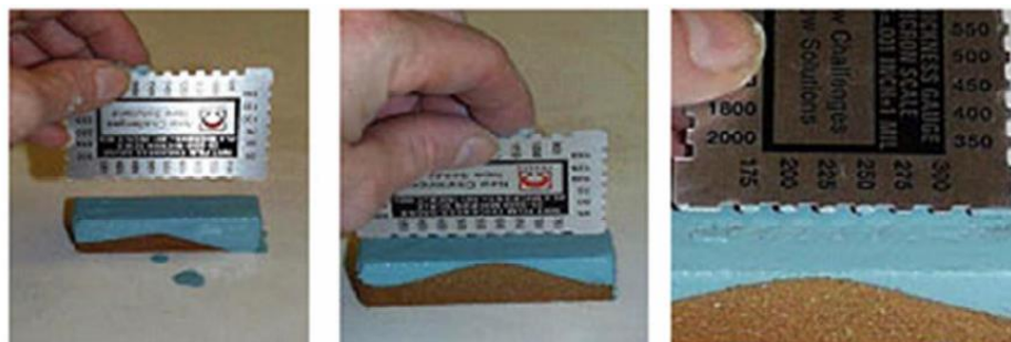
Figura 12: Medição da camada de espessura úmida de um revestimento de tinta
