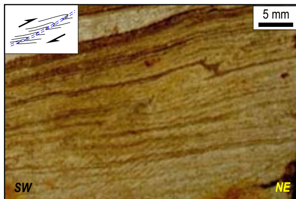
FOTOGRAFIA 4: Zona de cisalhamento de empurrão, desenvolvendo forte dobramento de arrasto no acamamento de um calcilito laminado. O arrasto denota deformação associada a uma fase precoce da sedimentação do calcilito. Poço 5V.
