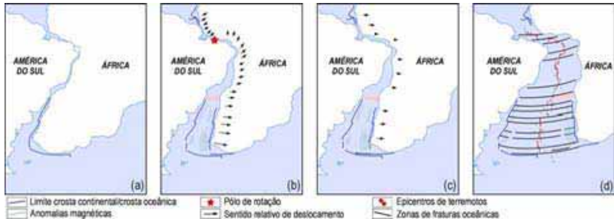
FIGURA 3-4: Modelo de evolução tectônica para a abertura do Oceano Atlântico Meridional envolvendo uma etapa inicial de rotação rígida (modificado de Rabinowitz & LaBrecque 1979). (a) Reconstrução pré-deriva para o Valanginiano, há cerca de 130 Ma. Para o ajuste, a África foi rotacionada em relação à América do Sul; (b) estágio rifte com rotação rígida ao redor de um pólo (estrela em vermelho) situado nas proximidades da cidade de São Luiz, no Estado do Maranhão. As setas indicam o sentido de movimentação da África em relação à América do Sul; (c) estágio drifte precoce ou wrench durante o Eoalbiano; (d) estágio de margem passiva a partir do Campaniano.
