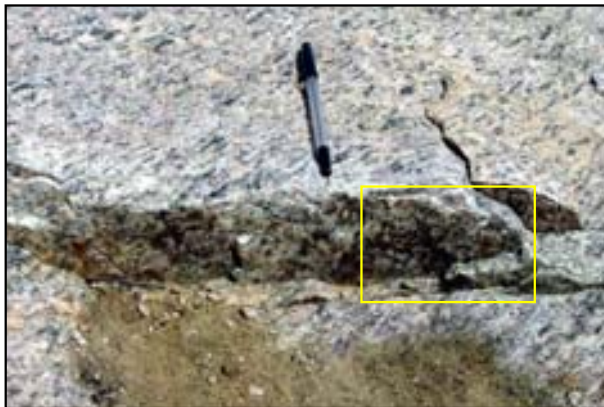
FOTOGRAFIA 3: Plano exposto de fratura com direção E-W (a tampa da caneta aponta para o norte) exibindo películas de óxido de ferro. Augen gnaiss na região a sudoeste de Fortaleza (CE). O quadro em amarelo indica a localização do detalhe mostrado na fotografia 4.
