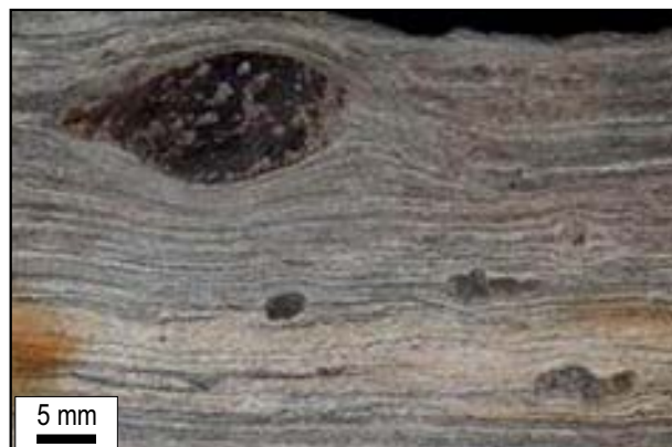
FOTOGRAFIA 1: Calcilito laminado exibindo laminação subhorizontal bastante conspícua, interpretada como um produto da superposição dos cisalhamentos C1 ao acamamento S0, originando a trama composta S0+C1. Notar a presença de clastos alongados que desviam a laminação. Poço 7V.
