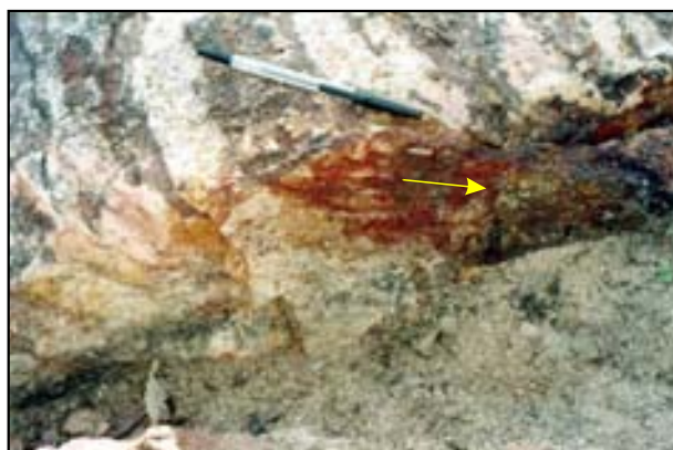
FOTOGRAFIA 5: Película de óxido de ferro desenvolvida sobre plano de falha com direção NNW-SSE (a ponta da caneta indica o norte). Corpo siliciclástico de Santana do Acaraú (CE). Notar a estria de baixo ângulo (indicada pela seta).
