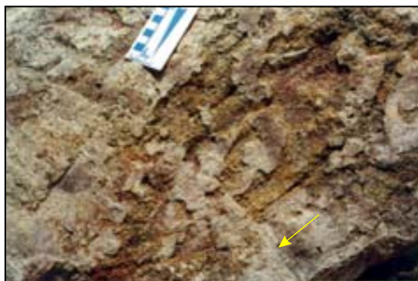
FOTOGRAFIA 3: Estrias (sentido indicado pela seta) desenvolvidas sobre películas silicosas, indicando movimento oblíquo (normal + transcorrente dextral) em plano de falha com direção NNW-SSE. Corpo siliciclástico de Santana do Acaraú (CE).
