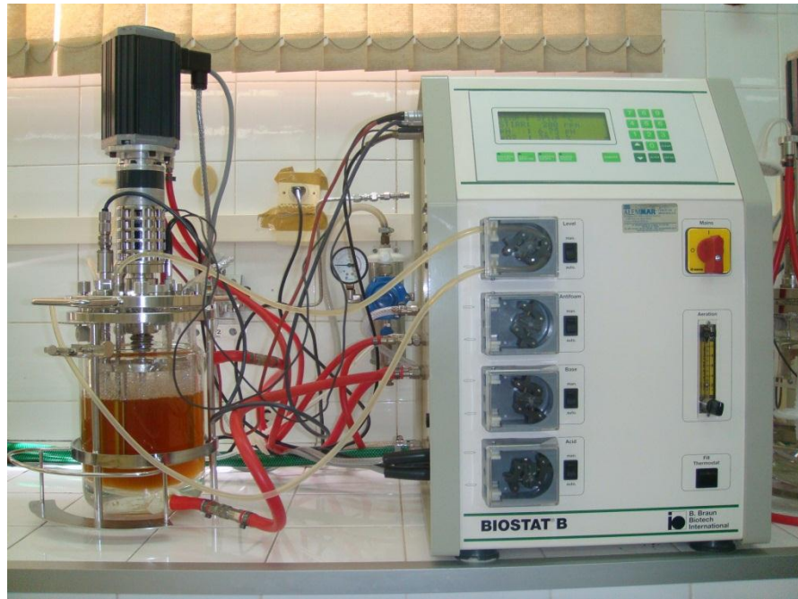
Figura 4 - Ilustra o biorreator de bancada onde foram realizadas as fermentações.
