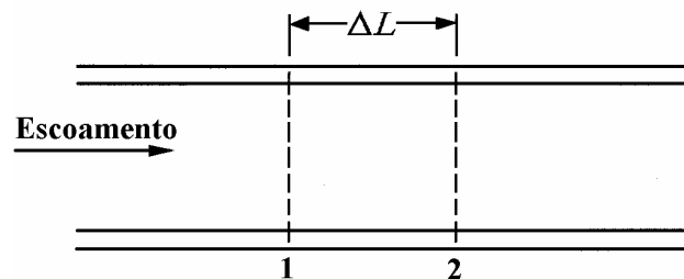
Figura 28 Elemento de um tubo capilar discretizado. (STOCKER; JONES, 1985)
