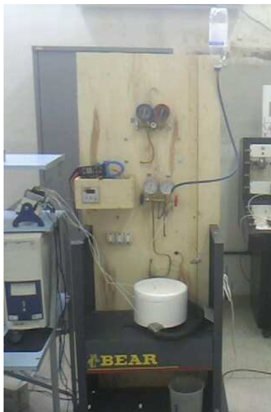
Figura 31 Foto da carga de refrigerante no sistema.
