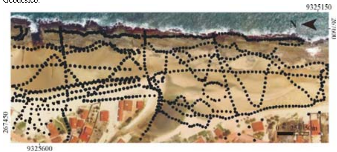
Figura 3.4 - Posição dos pontos na área de trabalho (estação 7 a 9), adquiridos com uso do GPS Geodésico.
