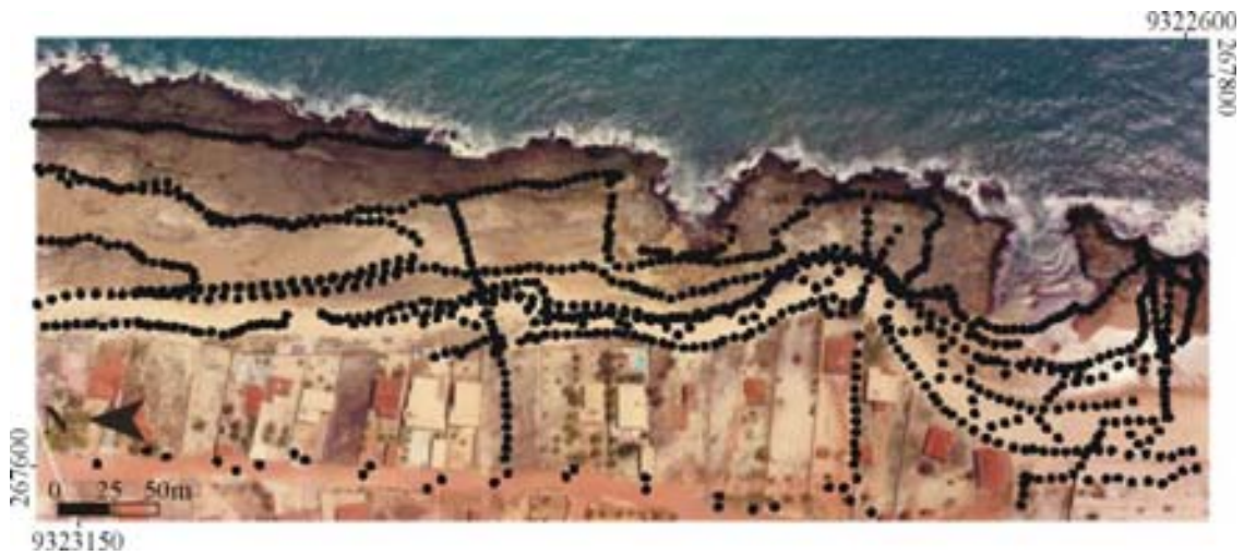
Figura 3.2 - Posição dos pontos na área de trabalho (estação 1 a 3), adquiridos com uso do GPS Geodésico.
