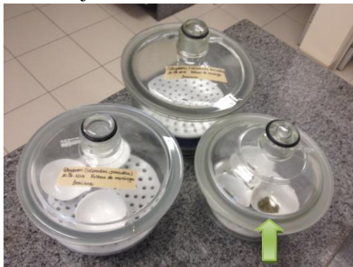
Figura 13 – Dessecadores utilizados o método de teor de umidade. Na figura tem-se a seta indicando a localização dos cadinhos já com amostras.
