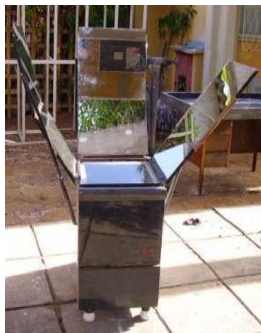
Figura 19 – Forno solar fabricado com um fogão a gás em desuso.
