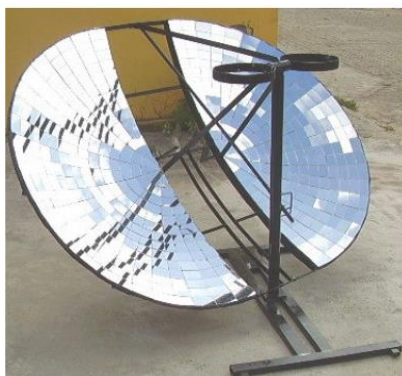
Figura 9 – Fogão solar do tipo concentrador elaborado por Lion.
