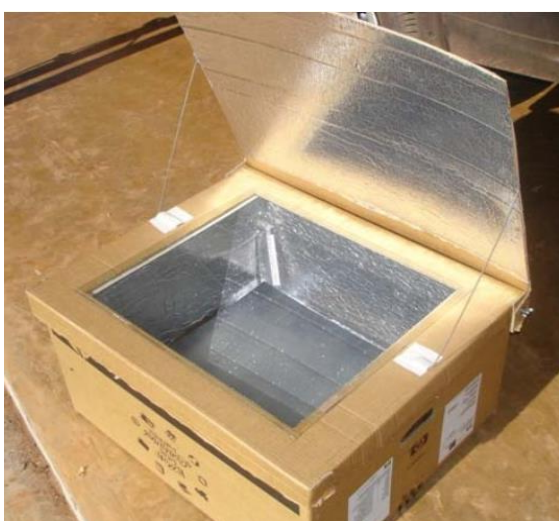
Figura 15 – Forno solar fabricado com caixas de papelão.
