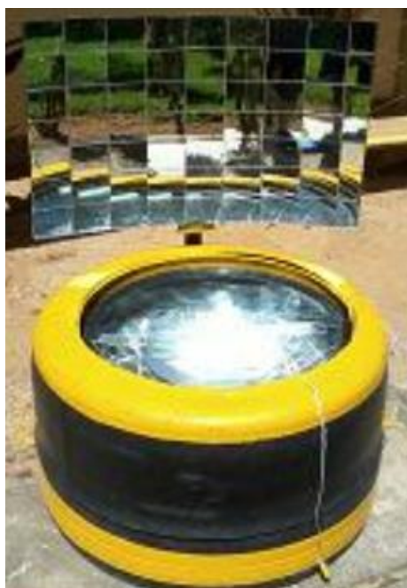
Figura 18 – Forno solar construído com pneus de automóvel em desuso.
