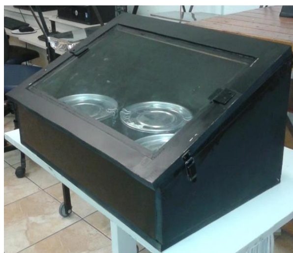
Figura 16 – Forno solar fabricado com MDF.
