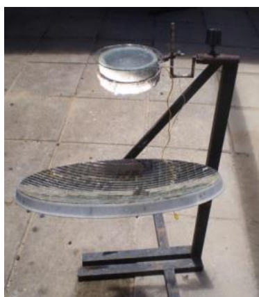
Figura 10 – Fogão solar concentrador construído a partir de antena parabólica.
