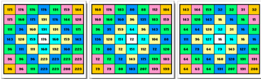
Figura 2.1: Exemplo de classes de distâncias para uma amostra de 7x7 píxeis nos canais R,G e B respectivamente
