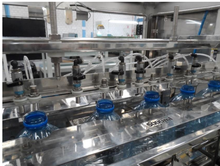
Figura 9 – Adaptação com divisores para envase de frascos de 5.000 mL
