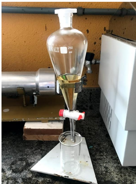
Figura 4.2. Lavagem do biodiesel
