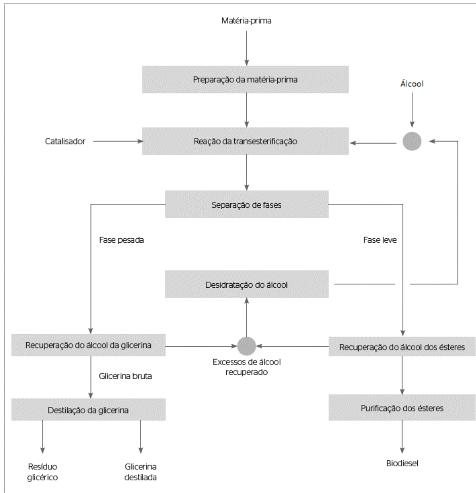
Figura 3.2. Fluxograma do processo de fabricação do biodiesel
