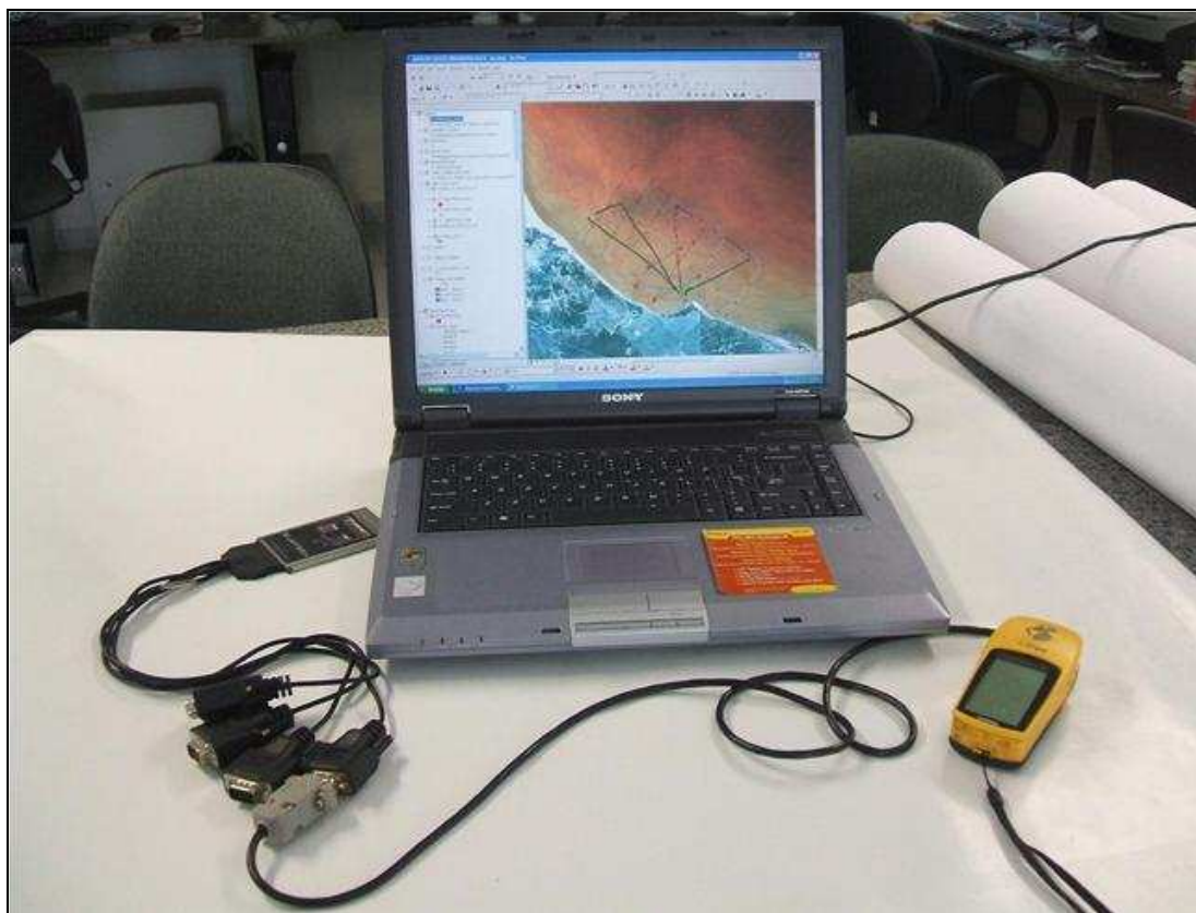
Figura 3. 9 - Computador utilizado para o sistema de navegação, em tempo real, da embarcação. Utilizando o sistema de posicionamento do GPS da Garmin, modelo E-trex, cartas básicas e malhas de amostragem.
