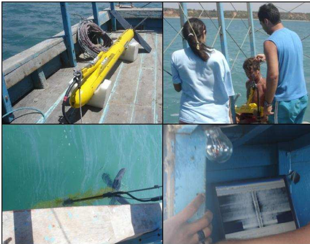
Figura 3. 10 - Sonar de varredura lateral marca Edgetech modelo 272-TD Towfish utilizado para o levantamento sonográfico.
