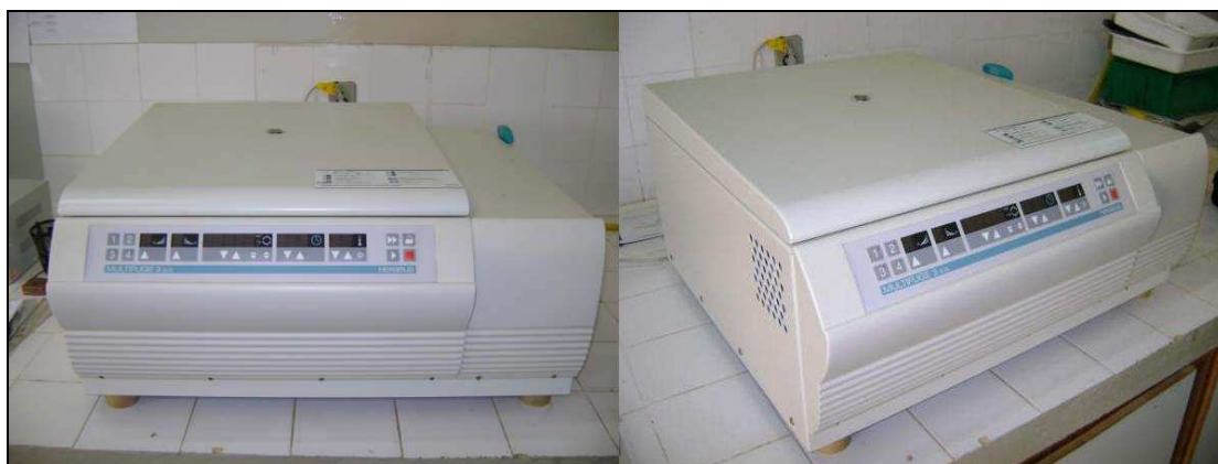
Figura 3.14 - Centrífuga Multifuge 35 R da marca Heraeus, com rotação de 4000 rpm, a uma temperatura de 25° C e aceleração e desaceleração na ordem de 9 rpm/s.
