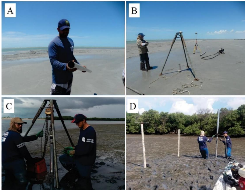
Figura 18: A - Tubo de alumínio utilizado na sondagem por vibração; B - Vista do tripé e testemunho coletado na área CPR11; C - Retirada do testemunho com uso da talha; D - Sondagem na área de referência em Frente a Diogo Lopes (RM), com posicionamento dos 3 testemunhos. Fonte: Vital et al. (2018a).
