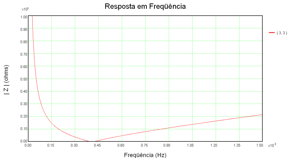
Figura 40 – Resposta em frequência da impedância do filtro de 7ª harmônica para o fator de qualidade igual a 50
