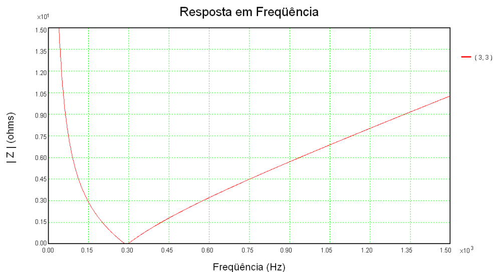
Figura 39 – Resposta em frequência da impedância do filtro de 5ª harmônica para o fator de qualidade igual a 50
