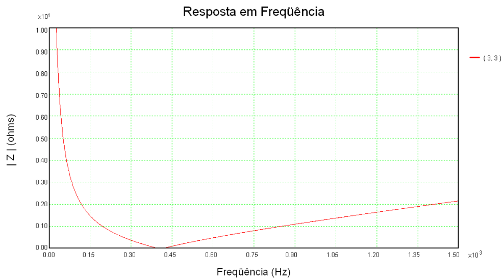
Figura 45 – Resposta em frequência da impedância do filtro de 7ª harmônica para o fator de qualidade igual a 80
