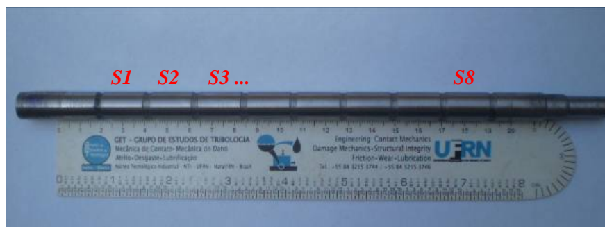
Figura 27 – Haste metálica subdividida em oito seções cilíndricas.
