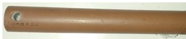
Figura 28- Fotografia de dois pedaços de cano de PVC, um com 18,0cm de comprimento com um orifício de 0,8cm de diâmetro em uma de suas extremidades.
