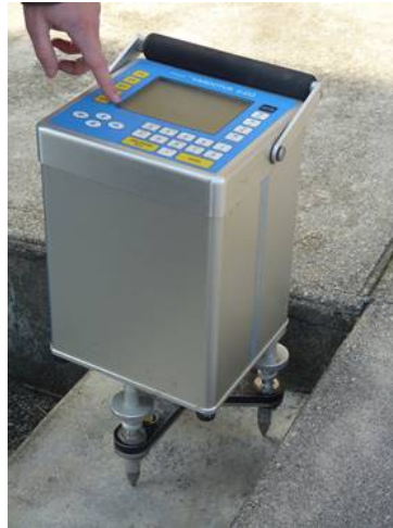
Figura 2 – Gravímetro com sistema de mola e massa.
