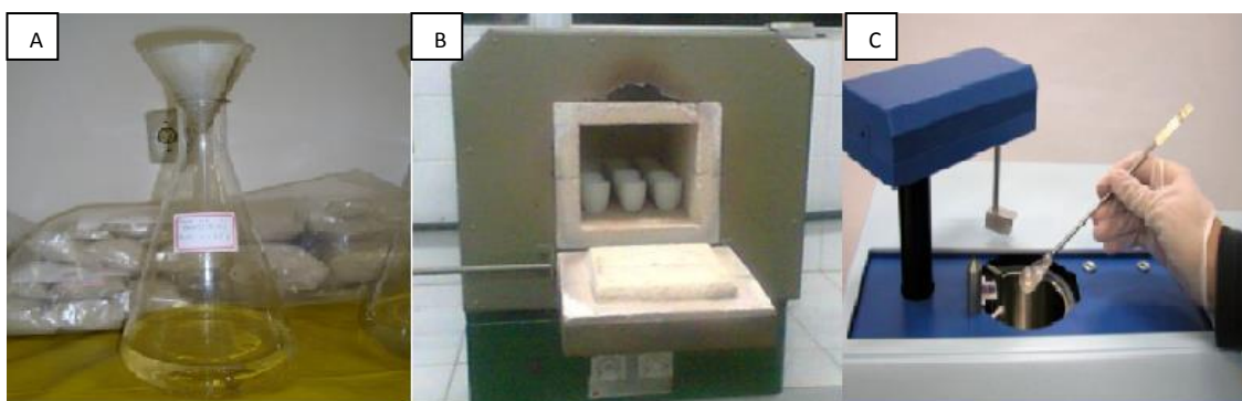
Figura 3.5- Etapas de laboratório. A)Análise do teor de carbonato. B)Teor de matéria orgânica. C) Granulômetro a laser Cilas 1180.
