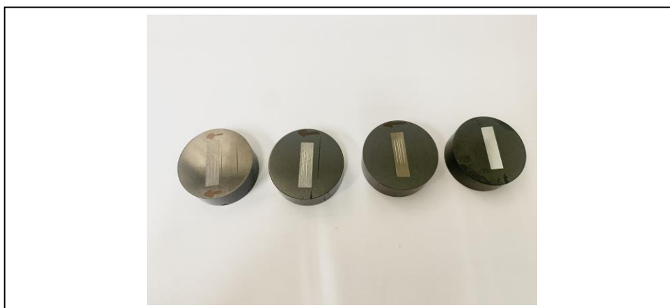
Figura 32 – Amostra riscadas pelo esclerômetro pendular
