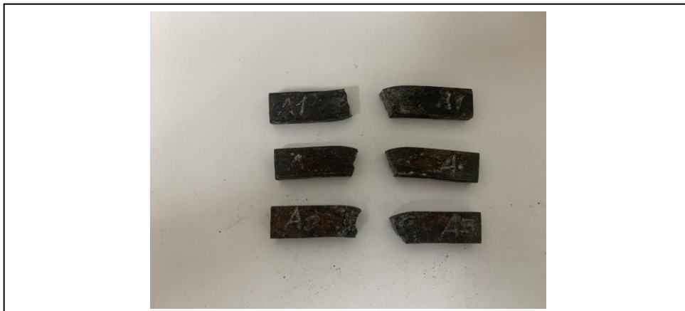
Figura 34 – Amostras com tratamento térmico 01 rompidas após o ensaio Charpy
