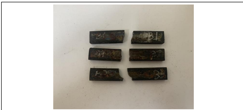
Figura 35 – Amostras com tratamento térmico 02 rompidas após o ensaio Charpy
