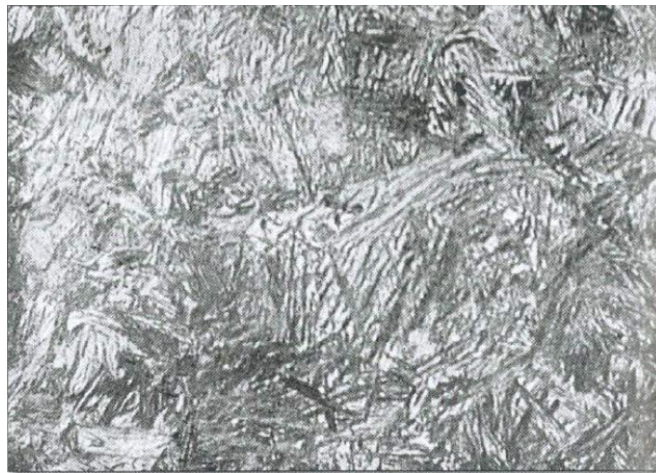
Figura 12 – Bainita produzida por tratamento isotérmico a 250°C
