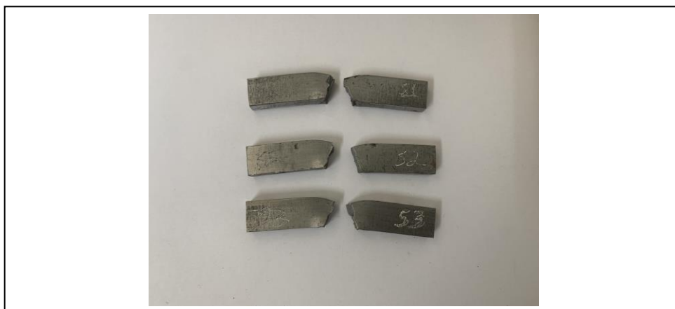
Figura 33 – Amostras sem tratamento térmico rompidas após o ensaio Charpy
