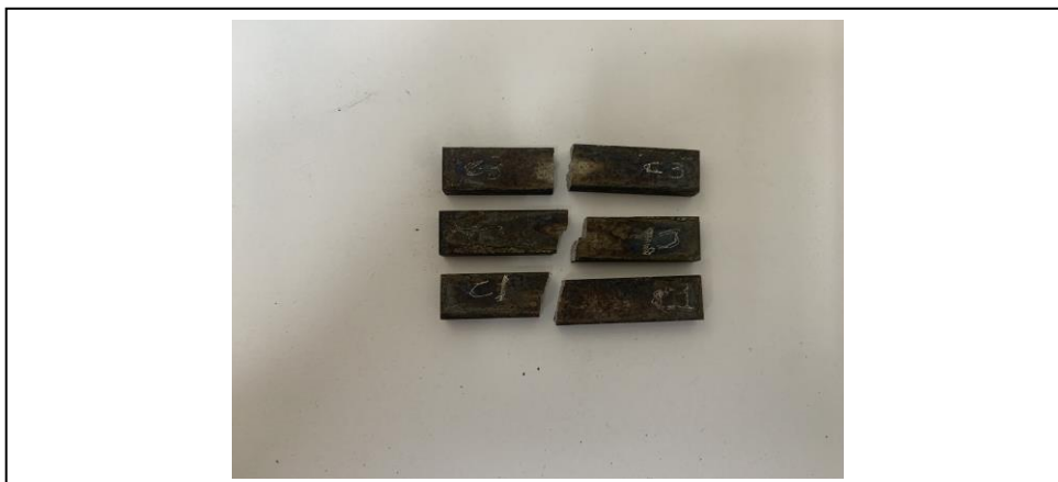
Figura 36 – Amostras com tratamento térmico 03 rompidas após o ensaio Charpy
