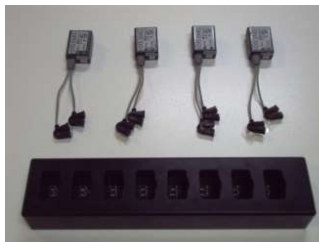
Figura 10. Sensores wireless do equipamento sEMG, Clinical DTS
