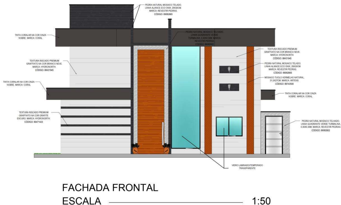
Figura 3 - Projeto arquitetônico de fachada.
